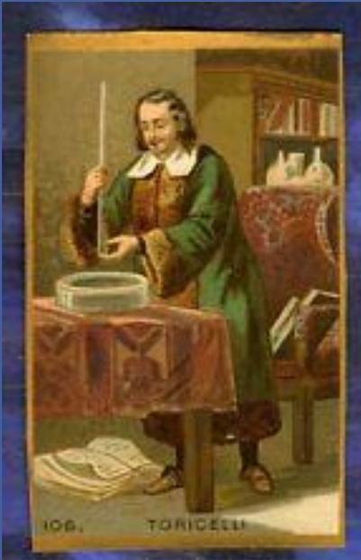
Torricelli a l'idée de remplir un tube de verre de mercure, de le boucher avec un doigt et de le retourner dans un bassin rempli de mercure.
