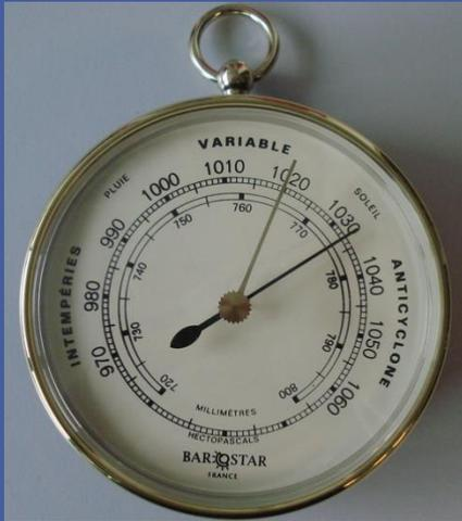
Dans un **baromètre anéroïde**, un capteur muni d'une membrane en équilibre agit comme détecteur. C'est la "capsule de **Vidie**" (du nom de son inventeur). Sous la pression exercée par l'air atmosphérique, la membrane subit une force qui est communiquée à un levier qui transmet le déplacement à une aiguille grâce à un mécanisme de précision. *Source : 3bscientific.fr*
