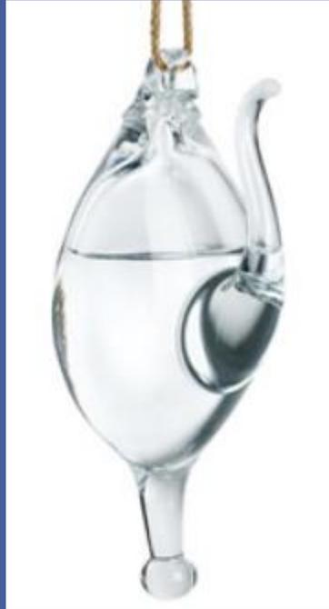
Basé sur les principes de Torricelli, ce baromètre utilise de l'eau à la place du mercure. Lorsque la pression atmosphérique augmente, le liquide du tube descend.
